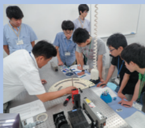
CDのトラックピッチを計測
